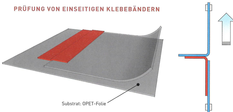
▲ Schematische Darstellung der Probenvorbereitung mit einseitigem Klebeband für die T-Schälprüfung (links). Daneben: Die T-Schälprüfung mit Klebebändern erfolgt mit zwei Geschwindigkeiten (10 mm/min und 100 mm/min). Rechts: Die Zugprüfung im Prüfstand
