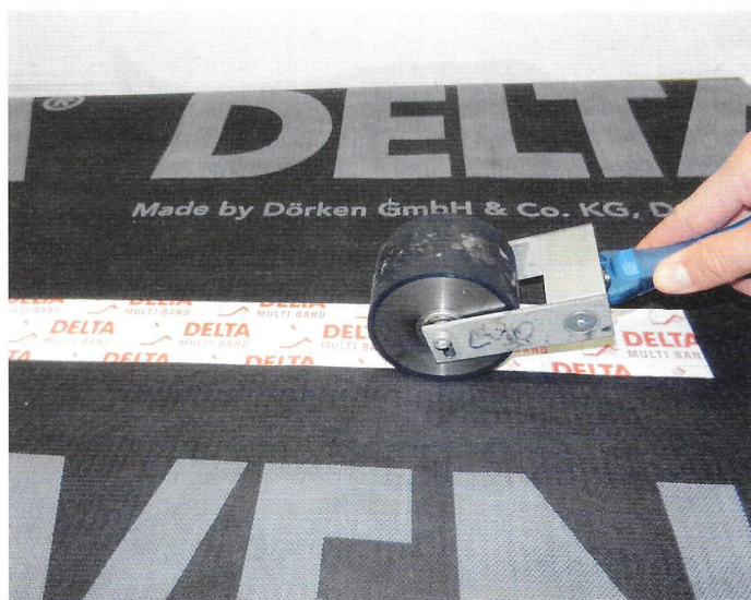
▲ Vor dem Test: Die Klebebänder werden mit einer 2-kg-Rolle angedrückt
