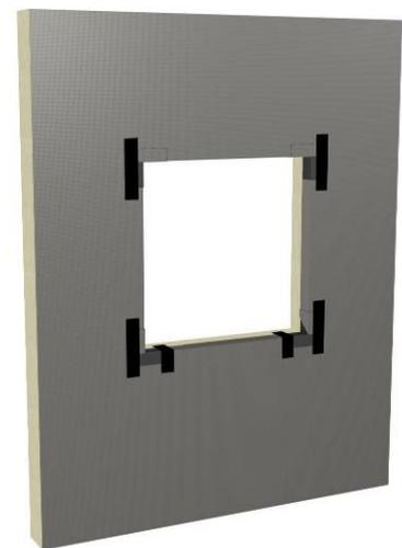
Figure 24d – Mise en place des bandes adhésives DELTA®-TAPE FAS
