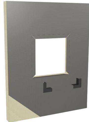
Figure 24a – Mise en place des coins DELTA®-FAS CORNER en partie basse de la baie
