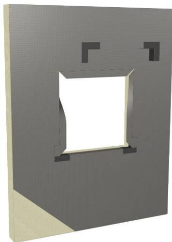
Figure 24b - Mise en place des coins DELTA®-FAS CORNER en partie haute de la baie
