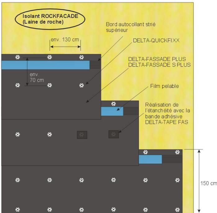
Figure 22 : pose horizontale du pare-pluie
