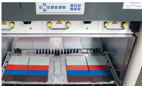
Simulazione radiazione UV nell'impianto di prova
