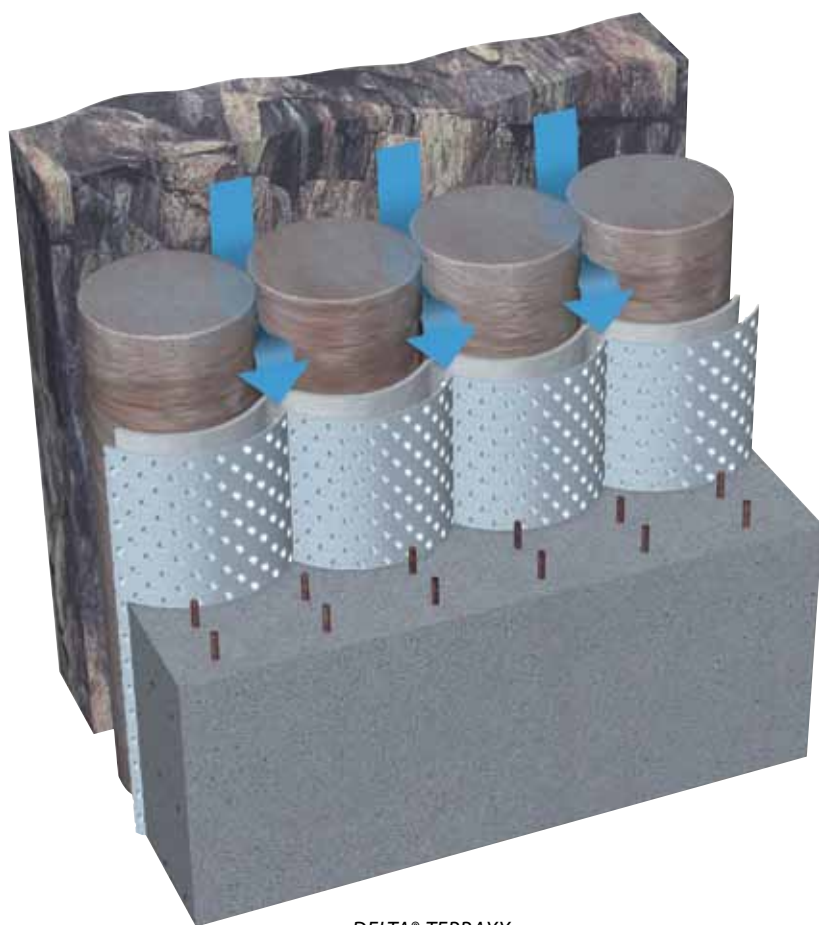
DELTA®-TERRAXX, конструкция стены в грунте.
