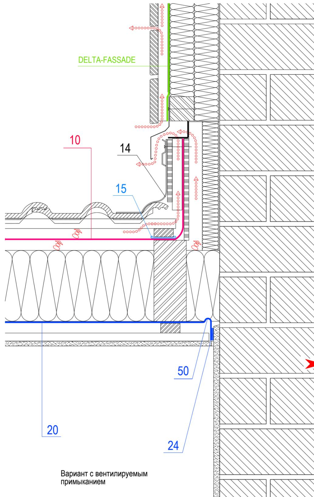
Вариант с вентилируемым примыканием
