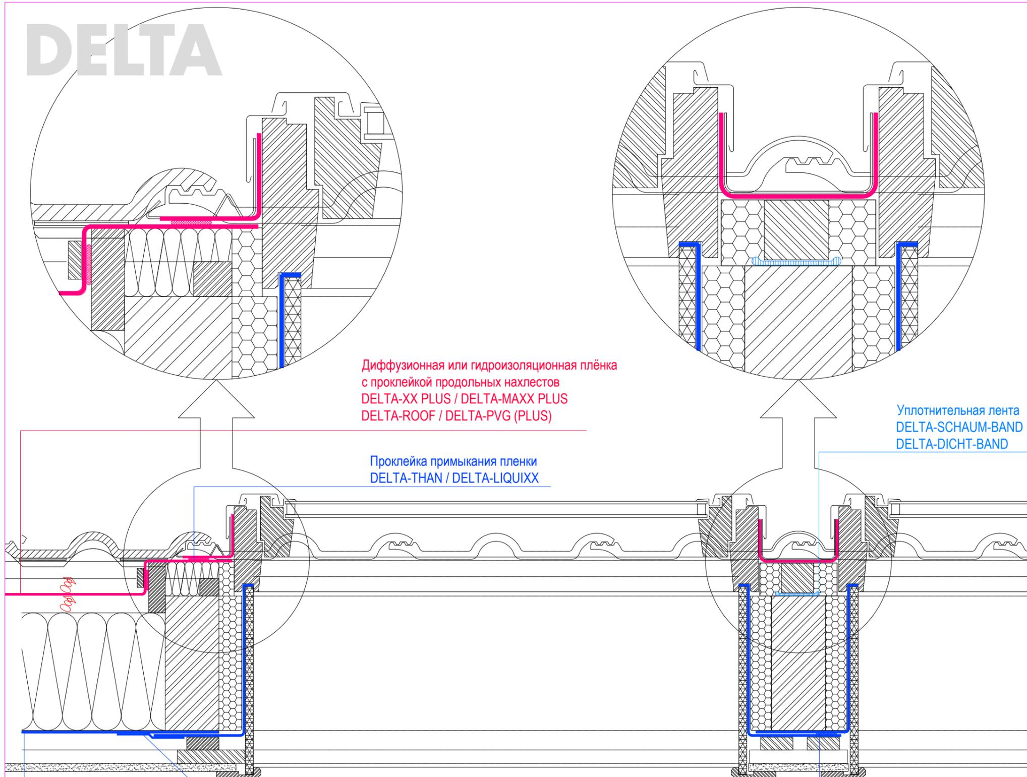
Диффузионная или гидроизоляционная плёнка с проклейкой продольных нахлестов
