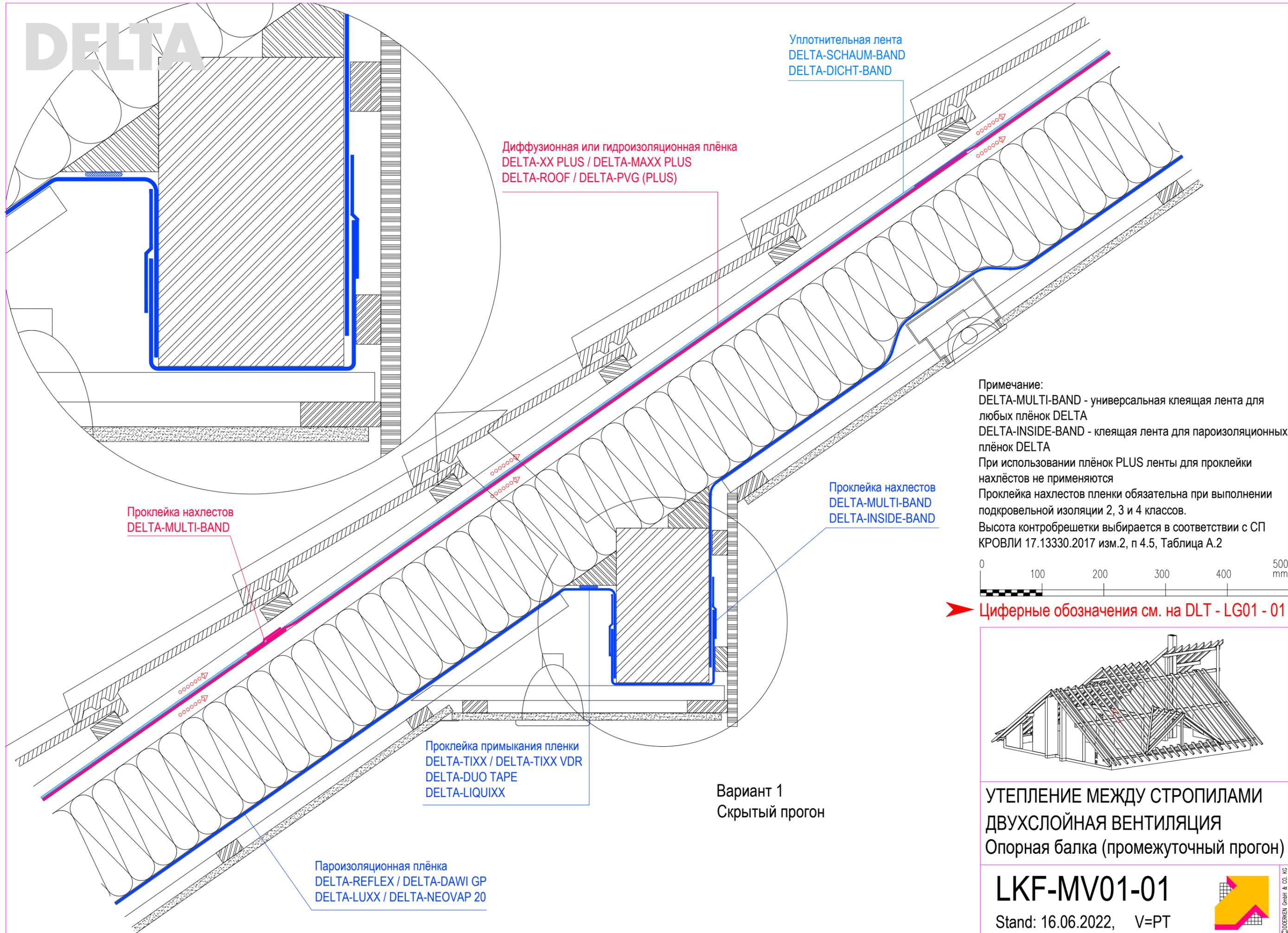
Диффузионная или гидроизоляционная плёнка
