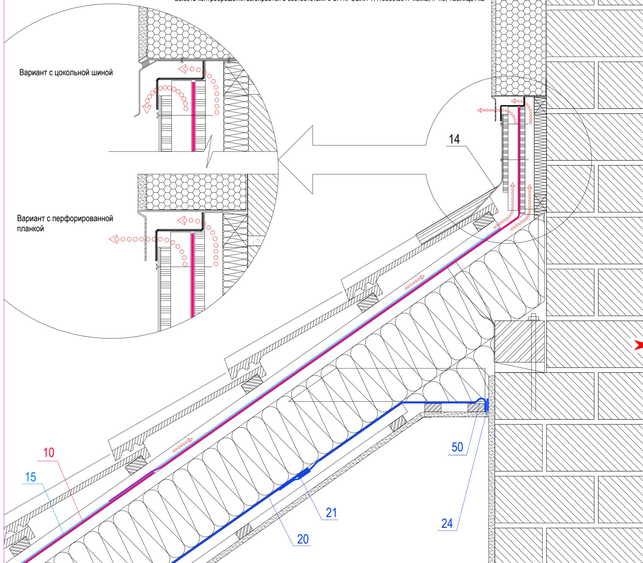
10. Диффузионная плёнка или гидроизоляционная плёнка
