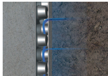
Princíp modernej drenáže pomocou DELTA®-TERRAXX, DELTA®-MS DRAIN. Voda sa prefiltruje cez textíliu. Bez nutnosti výmeny obsypu!
