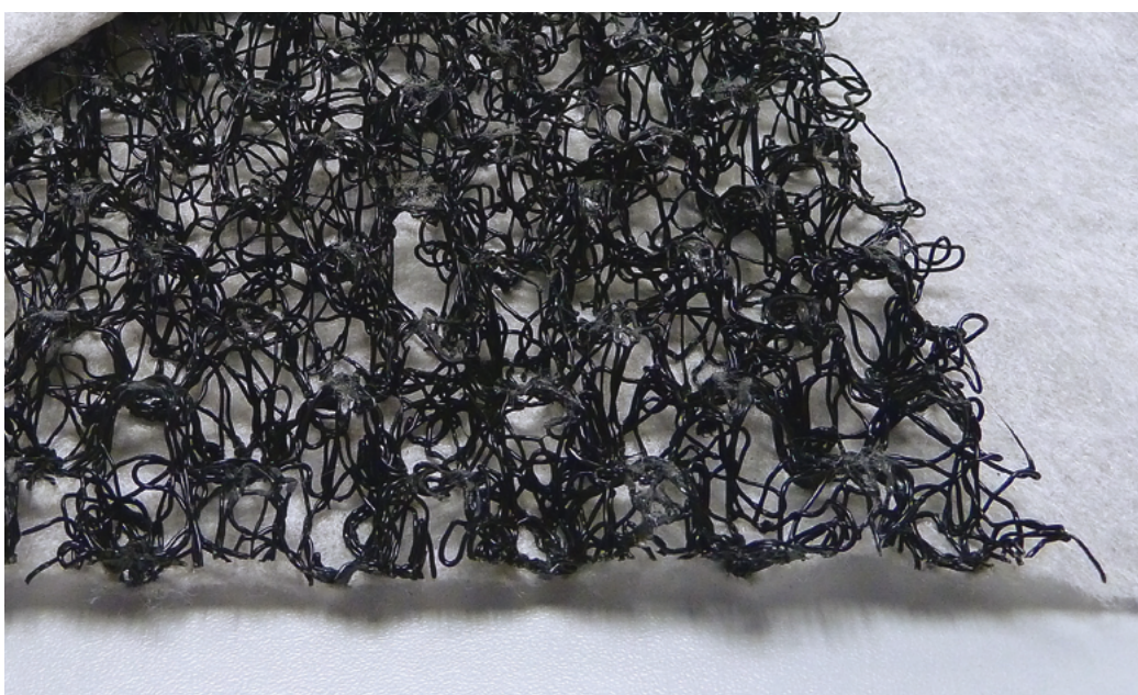
Polypropylène à mono-filaments extrudés.
