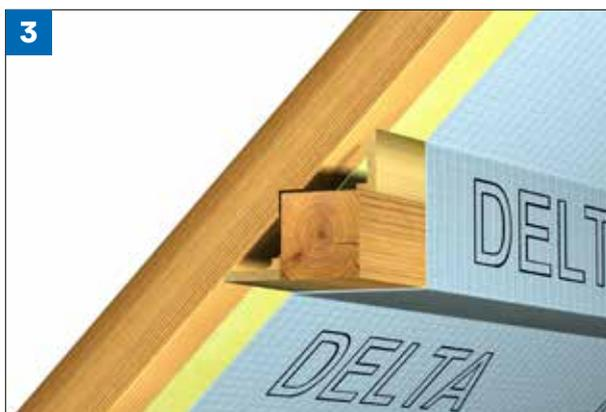
(Bild 3) Der Winkel z. B. zwischen Pfetten und Sparren sollte zur besseren Anpassung der Bahnen und zur Herstellung von sicheren und fachgerechten Verklebungen mit einem Keil oder Stellbrett aufgefüllt werden.
