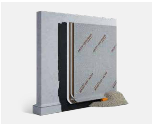
gleichmässige und vollflächige Lastverteilung auf der Abdichtung und schützt druckempfindliche Abdichtungen vor mechanischen Beschädigungen. Auf einer Längsseite verfügt die Noppenbahn über einen ca. 10 cm breiten glatten Überlappungsrand, der mit einer Klebezone zur einfacheren Montage ausgestattet ist. DELTA®-GEO DRAIN QUATTRO schützt z. B. Bitumendickbeschichtungen optimal vor Beschädigungen und erfüllt die Anforderungen der „Richtlinie für Planung und Ausführung von Dickbeschichtungen“.
