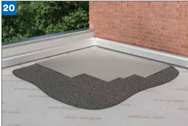
**(Bild 20)** Bei begehbaren Flächen, auf ebenen und festen Untergründen, wird die Splittschüttung direkt auf der verlegten Drainagebahn aufgebracht und anschliessend der begehbare Plattenbelag fertig gestellt.
