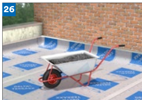
(obr. 26) Při použití fólie DELTA®-TERRAXX pod násypem střešního substrátu, je možné po položené fólii bez problémů pojíždět stavebním kolečkem. Pokud je proveden zásyp zeminou v tloušťce min. 20 cm, je možné po ploše během doby výstavby projíždět i kolovým nakladačem.
