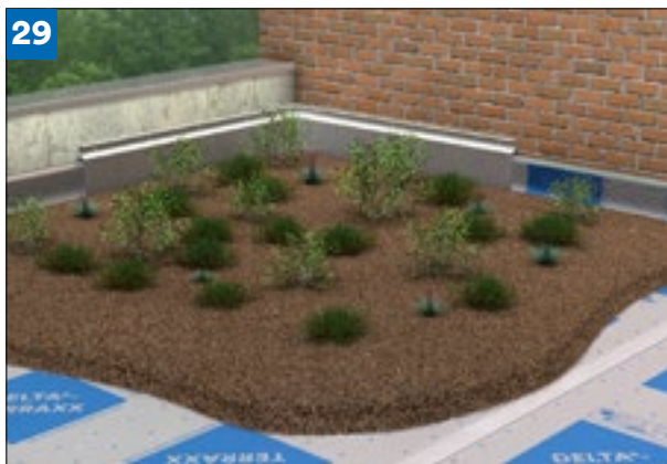
(obr. 29) U vegetačních střešních se substrát nanáší přímo na drenážní fólii v potřebné tloušťce a následně se vysazují rostliny. U nízko údržbových extenzivních vegetačních střešních se používá tloušťka substrátu mezi 8 až 15 cm, při intenzivních vegetačních střešních se podle druhu rostlin používají tloušťky substrátu mezi 20 až 100 cm a zde také může být umístěno dodatečné zavlažovací zařízení.
