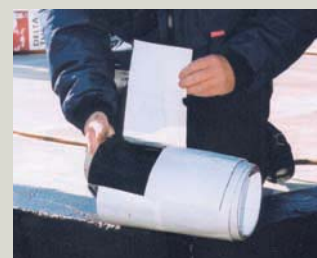
DELTA®-THENE-BAND T 300 Speziell zugeschnittene Streifen von DELTA®-THENE (0,3 x 10 m) für die Verlegung, z. B. an Kanten, Ecken, Hohlkehlen und Rohrdurchführungen. Mit geteiltem rückseitigem Trennpapier für eine einfache Verarbeitung.
